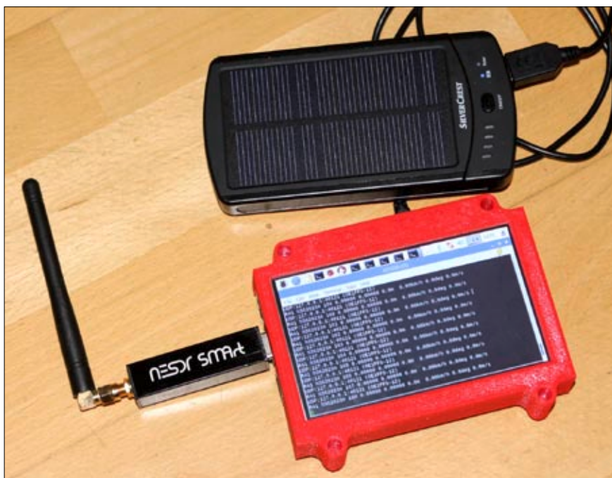
Die komplette Radiosonden-Empfangsanlage: RaspberryPi 3 mit 5-Zoll-Touchscreen, SDR-Stick von Nooelec, Software von OE5DXL (dxIAPRS + Sondenerweiterung)
