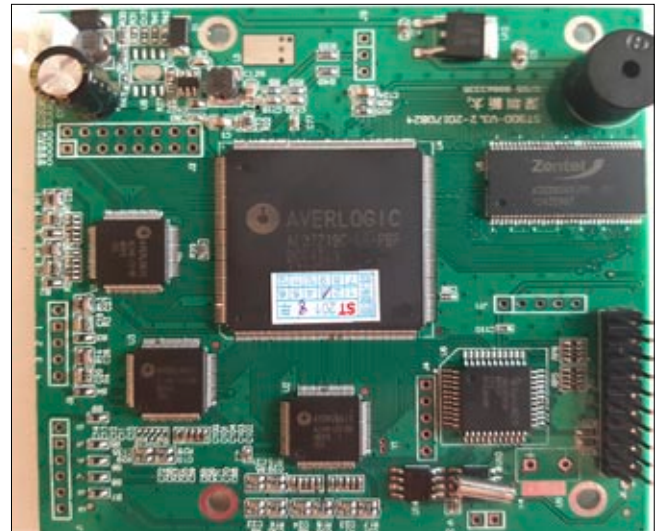
Das ist die Platine des neuen Video-Quad-Prozessors
