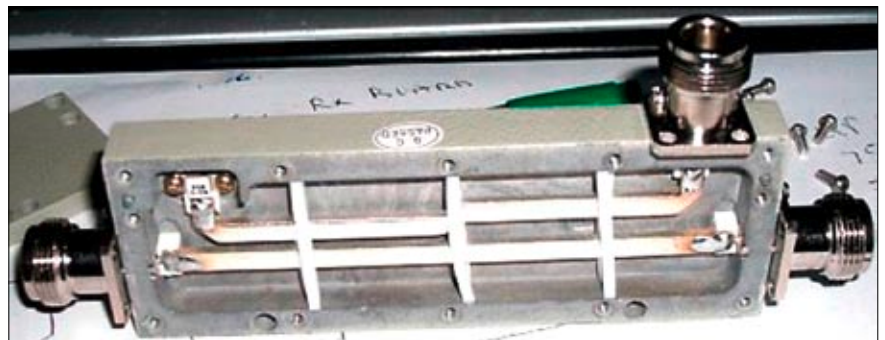
Bei dieser Abbildung werfen wir einen Blick in das Innenleben des 20-dB-Kopplers.
