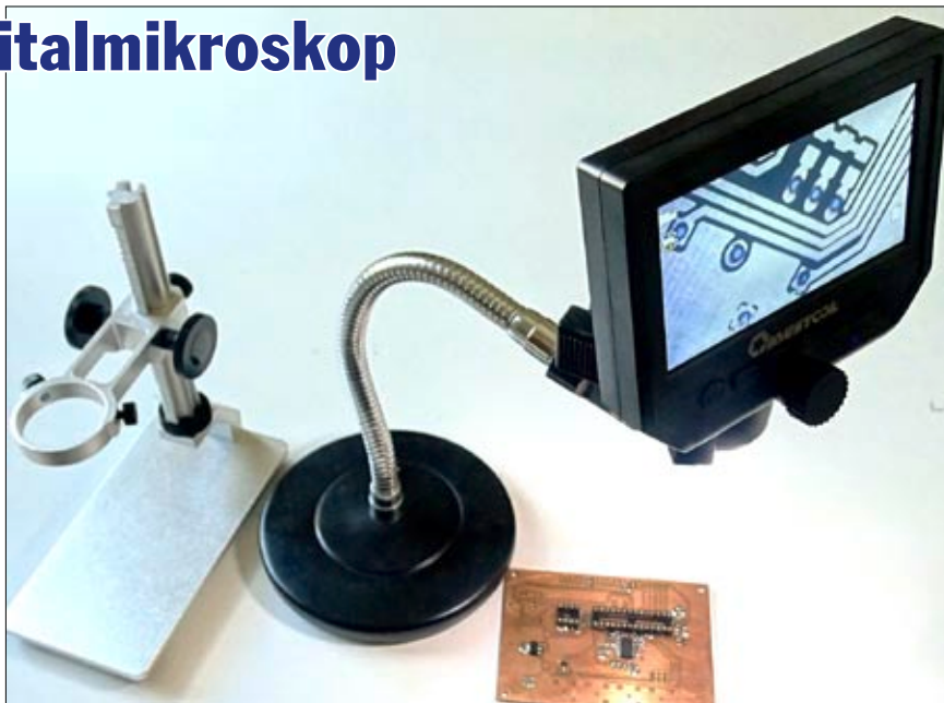
Das LCD-Digitalmikroskop G600 wurde hier in einen Mikrofonständer geklemmt, daneben der originale, höhenverstellbare Metallfuß.
