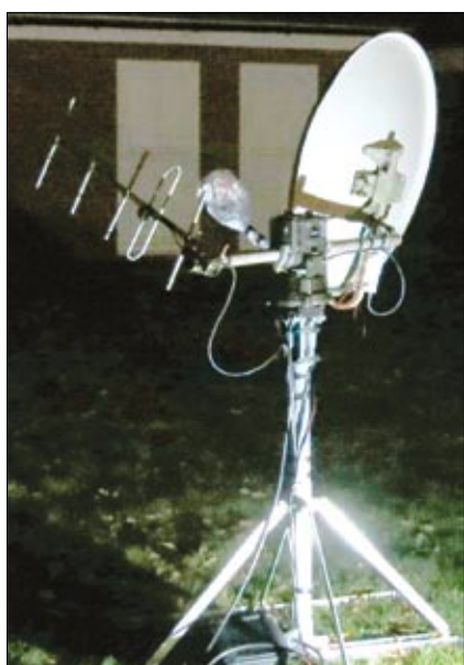
HamTV-Empfangsspiegel mit 2-m-Yagi
