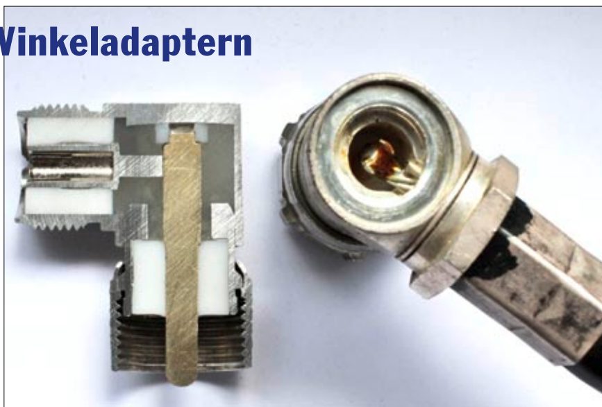
Ein Schnitt mit der Gehrungssäge offenbart den Schrottteil des von Reichelt vertriebenen UHF-Winkelstücks links. Die kommerzielle Kabelverlötung rechts, hier an einem älteren Winkelstecker gezeigt, geht dagegen in Ordnung.
