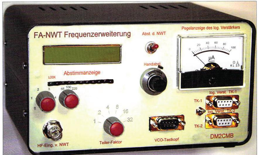
FA-NWT-Frequenzerweiterung, die Oszillatoren werden, je nach gewünschtem Frequenzbereich, als externe VCO-Tastköpfe angeschlossen.
