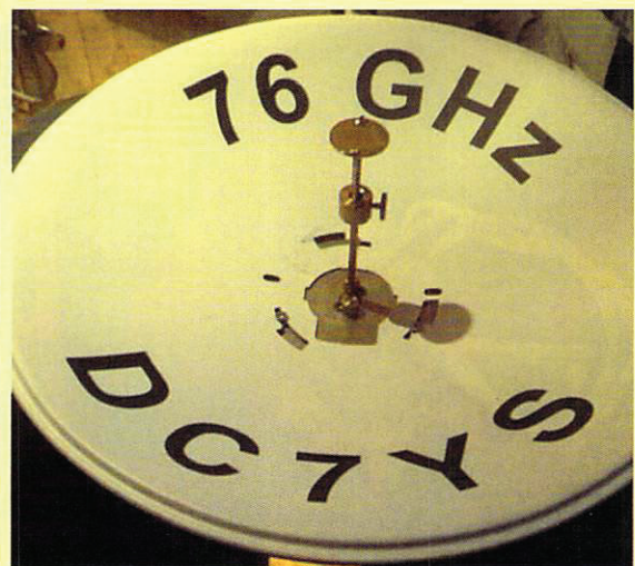
Bild 11: Eigenbau-Spiegel für 76 GHz
