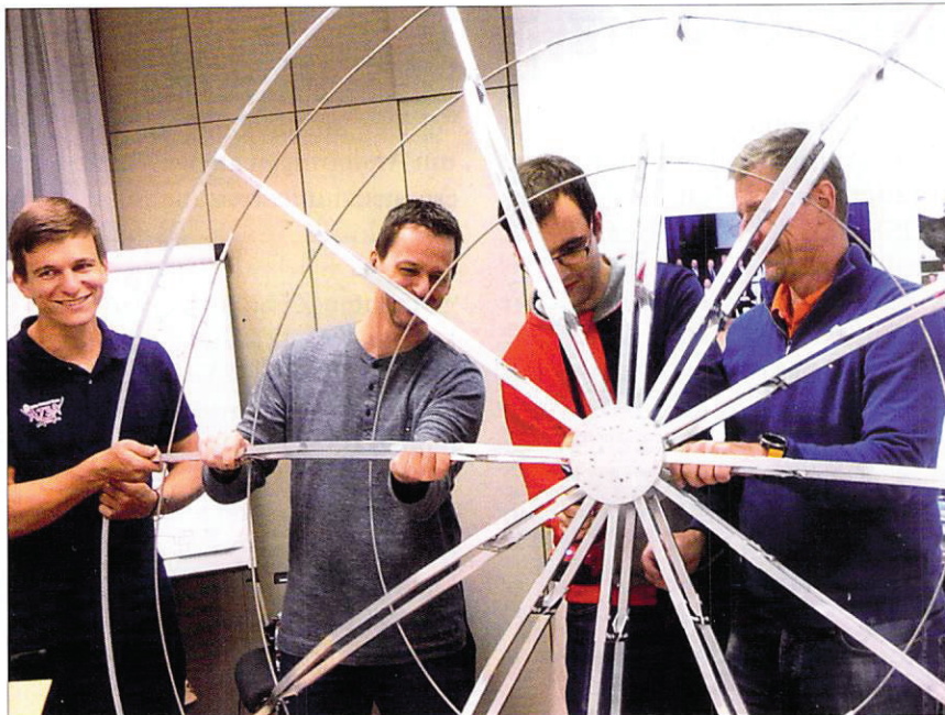
Das Amateurfunkzentrum-Team beim Aufbau des Drahtgitterspiegels.
