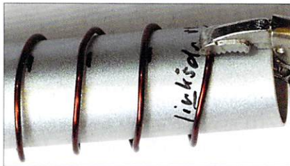
Abb. 3: Auf einem Alu-Rohr wird der CuL-Draht zu einer Helix-Spirale gewickelt.
