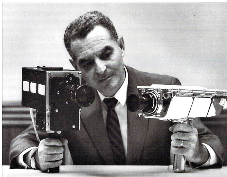
Stan Lebar, der Projektleiter der Apollo-Fernsehkameras von Westinghouse, zeigt die zeilensequenzielle NTSC-Farbkamera (für das Kommando-Modul in der Mondumlaufbahn) links und die monochrome Mondoberflächen-Kamera rechts
