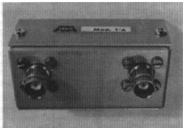
Bild 1 Außenansicht des Filters
