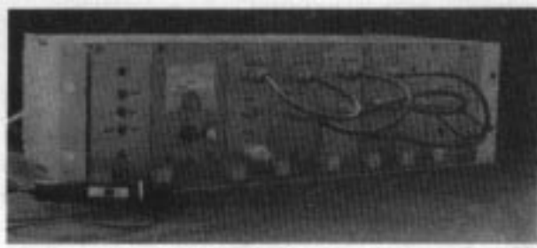
Bild 1 ATV-Sender in 19"-Einschubtechnik
