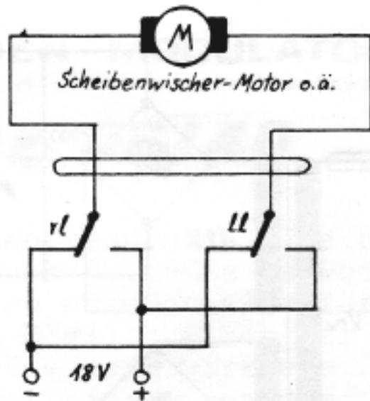
Die Relais, die der Motor schalten, wurden in den Abb.2 und 3 mit RL und LL bezeichnet. Die Abb.4a zeigt die Schaltung eines mit Netzspannung betriebenen Motors mit den zugehörigen Relaiskontakten rl und ll, der Relais RL und PL.
