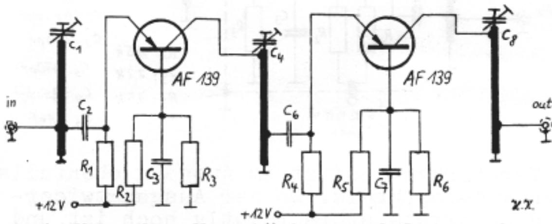
Der Aufbau der Verstärker erfolgt am besten in einem aus Messingblech (0,4..0,8) oder kupferkaschierten Pertinax selbst angefertigten Kästchen, deren Maße der Abb. 3 zu entnehmen sind. Die einzelnen Wände sollten vor dem Zusammenlöten versilbert werden. Ebenso die Leitungstücke. Als Trimmer finden die allgemein bekannten UHF-Rohrtrimmer Anwendung. Für die Koppel- und Abblockkondensatoren eignen sich besonders sogen. „Klatsch“-Kondensatoren, bei denen die schädliche Zuleitungsinduktivi-
