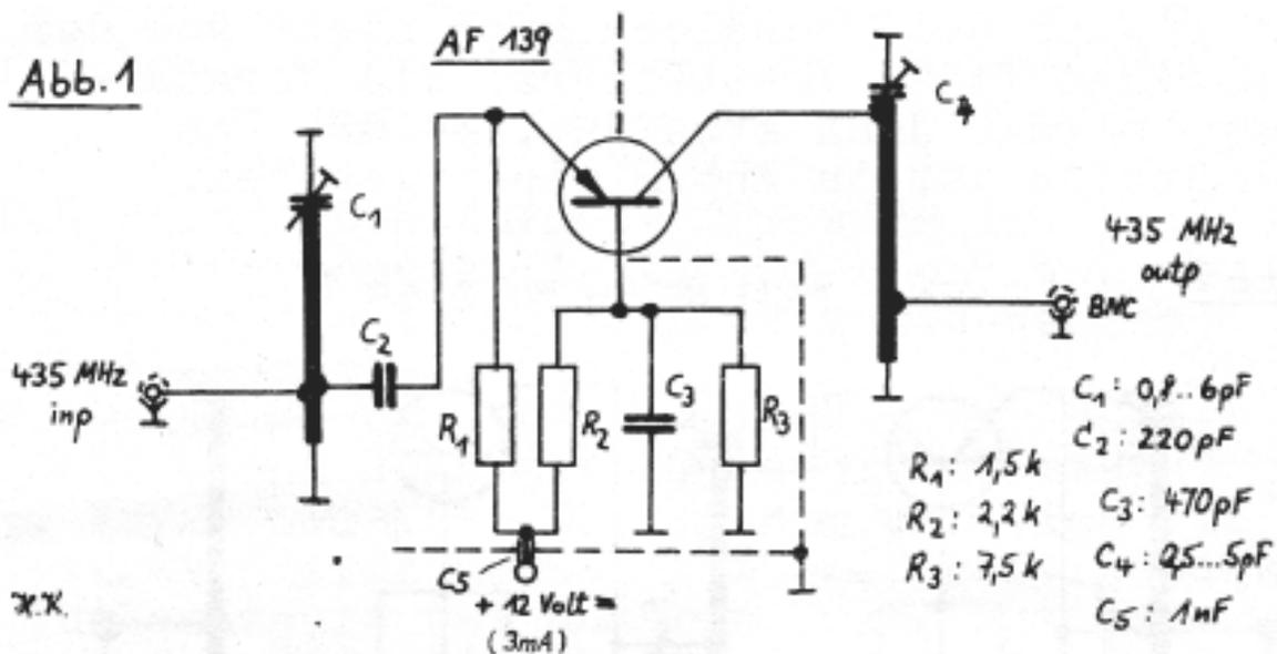
Der Verstärker besitzt im Ausgang ebenfalls einen 1 / 4-Topfkreis. Da der Ausgangswiderstand des Transistors relativ hoch ist und sich die Strom- und Spannungsverteilung auf dem Leitungskreis nicht ändert, kann der Kollektor des Transistors fast voll an den Kreis angekoppelt werden. Die Auskopplung erfolgt, genau wie im Eingang, galvanisch im Strommaximum auf 60 W.
