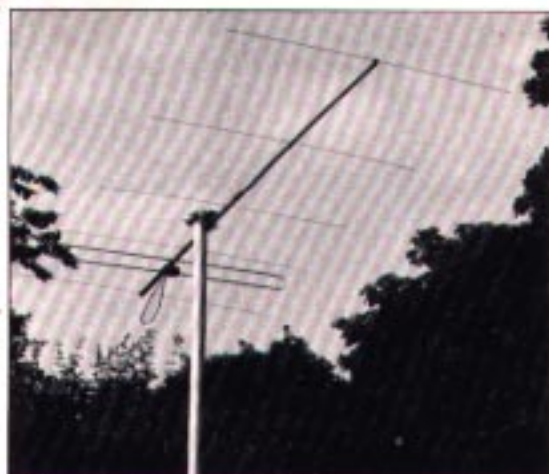
FX 210, 2,15 m lang, 1020 Gramm, 9,1 dB über Vergleichsdipol!
