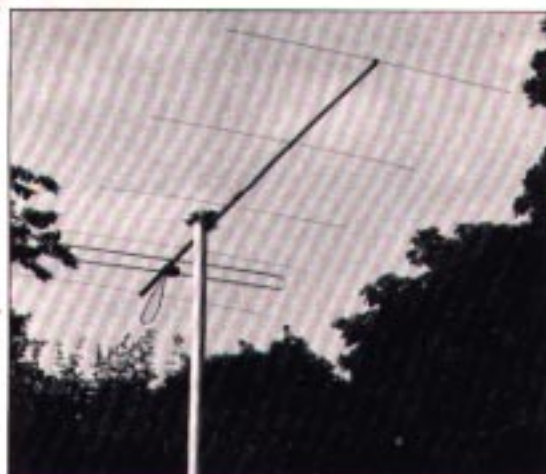
FX 210, 2,15 m lang, 1020 Gramm, 9,1 dB über Vergleichsdipol!
