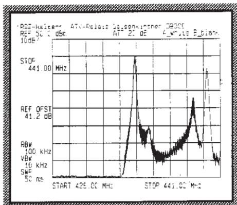
Bild 1 zeigt das 70 cm-Ausgangsspektrum. Der Bildsender ist mit einer Farbtrappe moduliert, allerdings ohne 5 MHz Videofilter.
