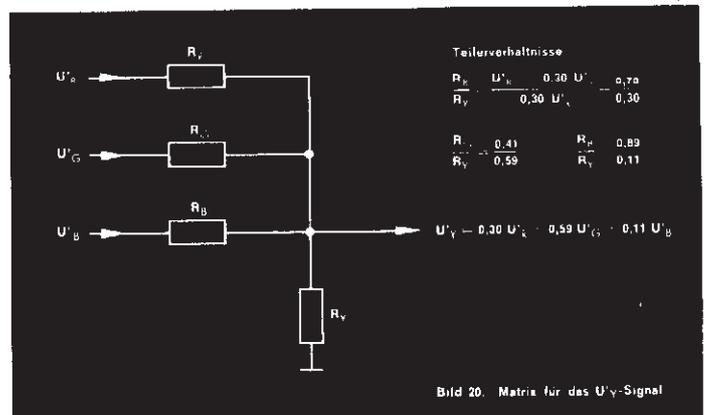
Bild 20. Matrix für das  $U'_Y$ -Signal
