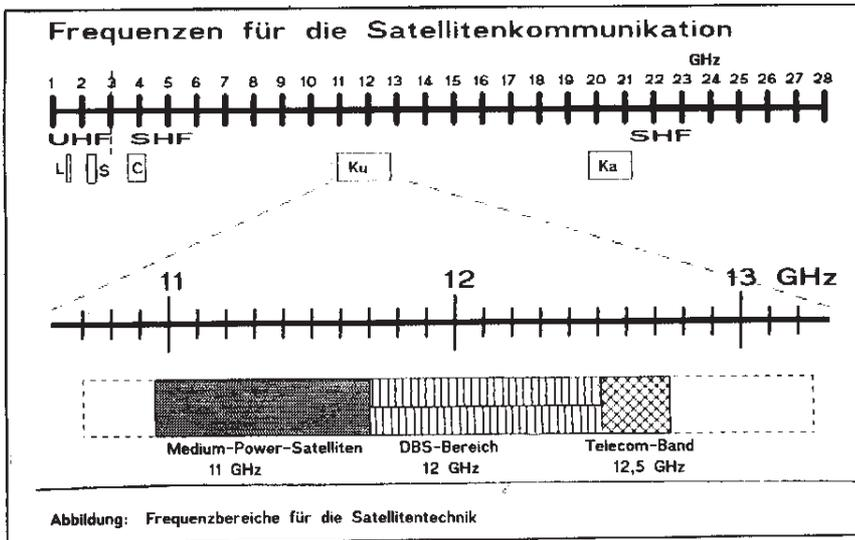
Abbildung: Frequenzbereiche für die Satellitentechnik
