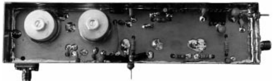
Zeichnung des Resonatorfilters
